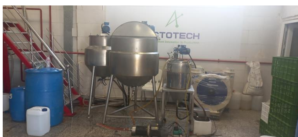
شکل ۲ دستگاه های صنعتی تولید امولسیون مخزن استیل مجهز به همزن مکانیکی است که برای گرم کردن، همزدن و میکس کردن فاز روغن و آب به کار می‌رود.
