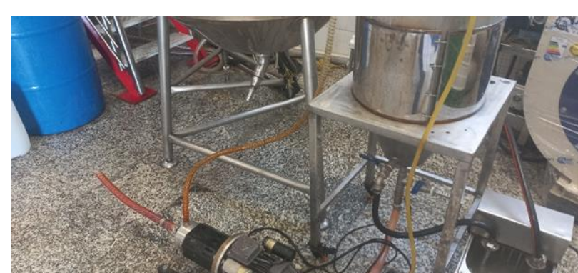
شکل ۳ هموژنایزر مکانیکی که سیال را تحت فشار از مخزن به سمت مسیر خط تولید منتقل می‌کند. این دستگاه با ایجاد برش و فشار بالا به خرد شدن قطرات روغن کمک می‌کند و برای تولید امولسیون‌های یکنواخت استفاده می‌شود.
